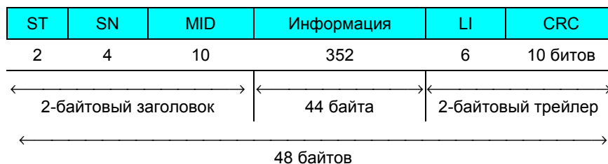
Структура AAL3/4 SAR PDU
